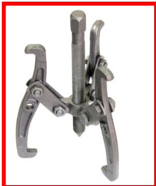
EXTRACTOR DE TRES PATAS (VOLANTES O PIÑONES)
